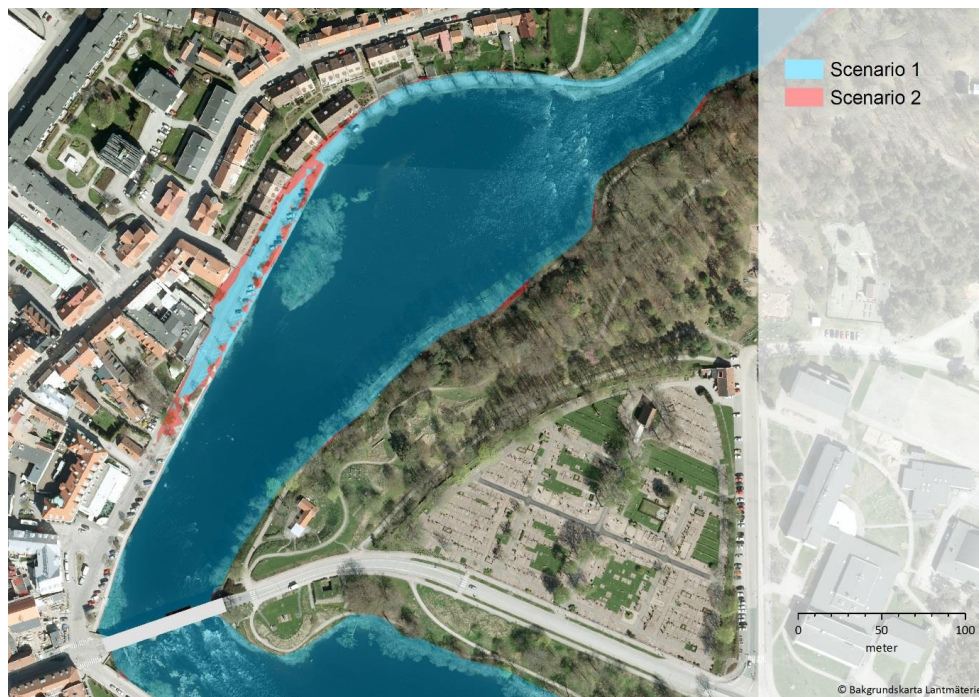
Figur 4-30. Jämförelse av översvämningsutbredning beräknad med metod från GU (scenario 1) respektive från SMHI/RCP8.5. Figuren visar utbredningen år 2100 vid ett 100-årsflöde i Ätran och med en framtida 100-årsnivå i havet som randvillkor.
